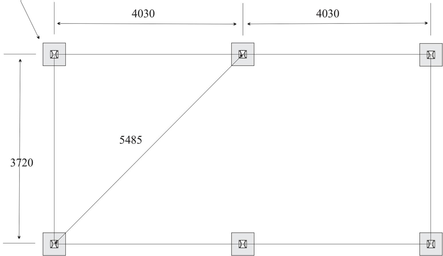
Si un portail coulissant doit être installé sur le long pan, prévoir une longrine de 300/150 sur une longueur de 2 fois le vantail
